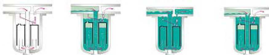
Слика 8.32 Принцип рада одвајача кондензата са звоном
