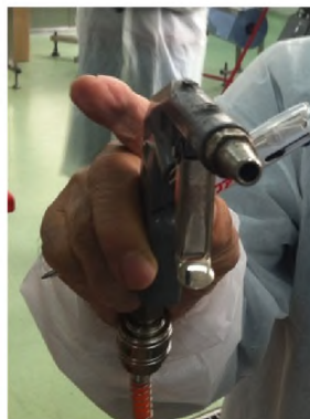
Слика 12.20 Ваздушни пиштољ за компримовани ваздух
